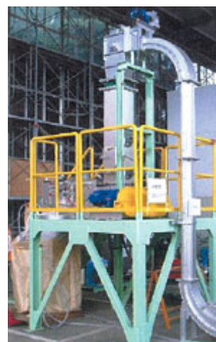
重金属類不溶化装置
